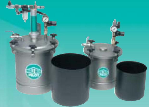
Die Edelstahl-Druckbehälter der Baureihe LDG sind für einen max. Betriebsüberdruck von 6 bar ausgelegt. Aufgrund klappbarer Kreuzgriffverschlüsse kann der Behälter bequem und schnell geöffnet werden. Der Deckel bietet hinreichend Platz für eine zusätzliche Rührwerksbestückung.
