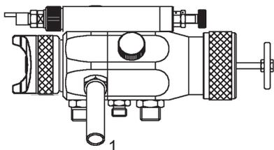
Benutzen Sie hierzu den Befestigungsbolzen (1), Durchmesser 12 mm. Andere Befestigungsvorrichtungen auf Anfrage.
