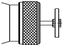
1. Ziehen Sie die Zugstange der Spritzpistole nach hinten. Die Materialzufuhr wird geöffnet und Materialkanal und -düse werden gereinigt.
