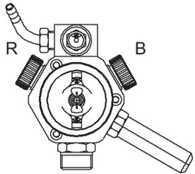
Mit Hilfe der beiden Regelschrauben R und B lässt sich ein optimales Spritzbild einstellen. Die Regelschraube (R) beeinflusst die Rundstrahlluft, die Regelschraube (B) die Breit- bzw. Flachstrahlluft.
