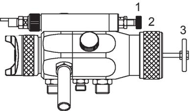
Durch Einschrauben der Stellschraube (1) können Sie die Materialdurchflussmenge der B-Komponente verringern. Durch Ausschrauben erhöhen.
