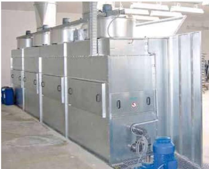
Rückseite mit ausziehbaren Luftfilterkästen
