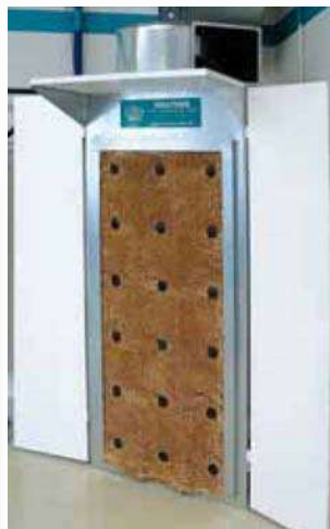
Typ 90 WS, Größe 10. Die Spritzwand ist hier zur bequemen Reinigung mit Abziehlack beschichtet.
