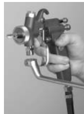
4. Doppelnippel 1/4 - 3/8" einschrauben und festziehen (SW 17).
