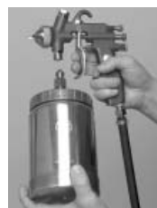
6. Alternatief: onderbeker bevestigen (alleen bij HD-uitvoering mogelijk); luchtkap verwisselen (HD-luchtkap).
