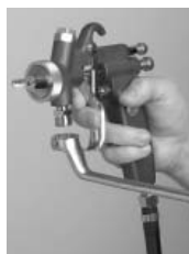
4. Dubbele nippel 1/4" - 3/8" erop schroeven en vastdraaien (SW 17).
