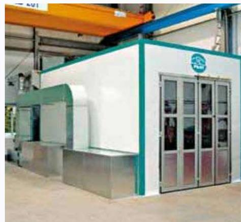
Energieeffiziente Sparvariante. Kabine mit seitlich angebrachten Absaugkanälen. Die diagonale Luftführung bietet nicht nur Energievorteile. Auch die Anschaffungskosten sind günstiger als bei Unterfluranlagen.
